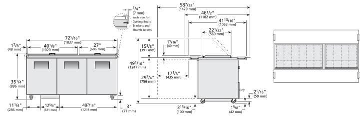
ELEVATION RIGHT VIEW PAN LAYOUT
